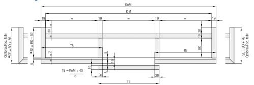
\* Seite demontierbar für Türmontage Removable side for door mounting Côte demontable pour montage de porte
