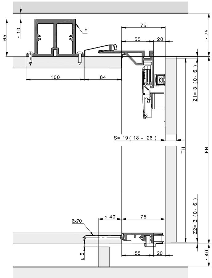
\* Verstärkungsprofil bei 3- und 4-türigen Anlagen ohne Mittelwände
