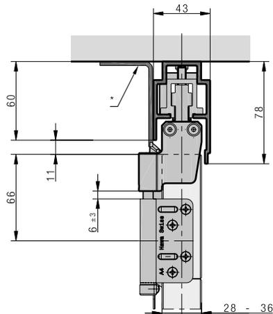
\* Schliessblech 30464 oder bauseitiges Schliessblech
