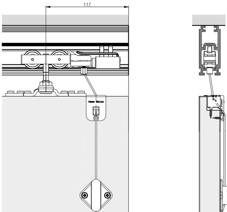
**Schiebeladen-Arretierung in Kombination mit Hawa Frontslide 60 B**
