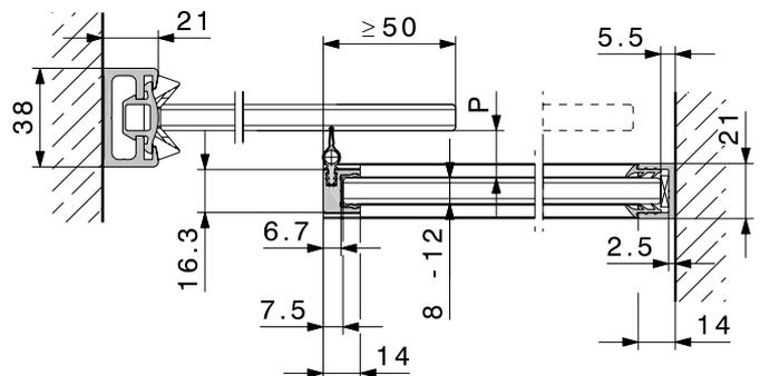
**Glasabstand «P» zu vertikalem Dichtungsprofil**
