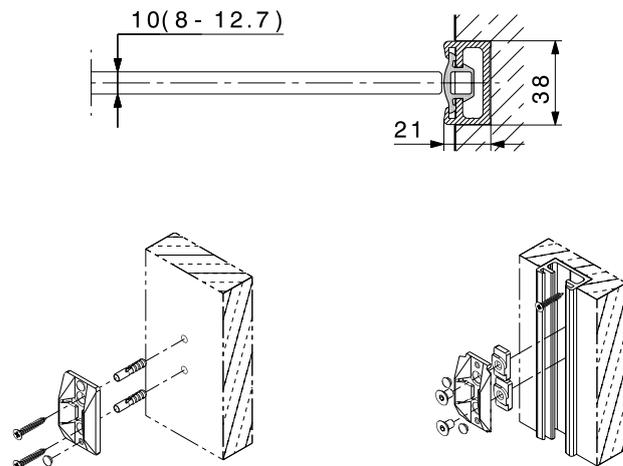
**Boden-/Wand- und Gummiprofil zu Festverglasung**
