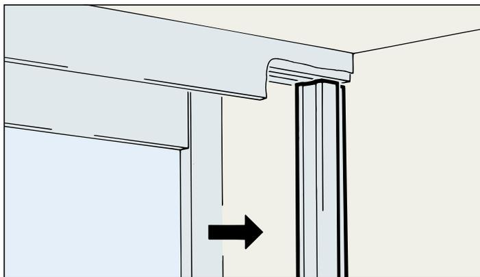
**System: Wandausgleichsprofil, für oben- und untenlaufende Anwendungen, in Holz und Alu/Glas.**
