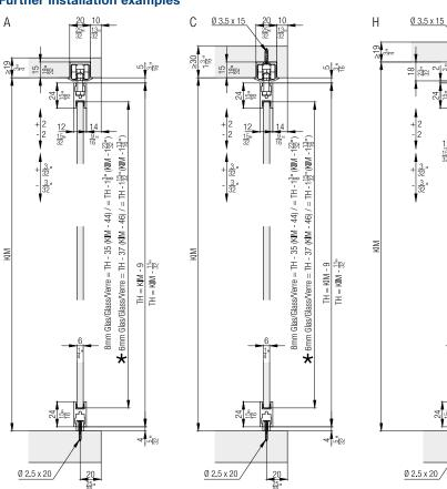
★ Zentrierhilfe für 6mm Glas Centering help for 6mm glass Aide de centrage pour verre 6mm
