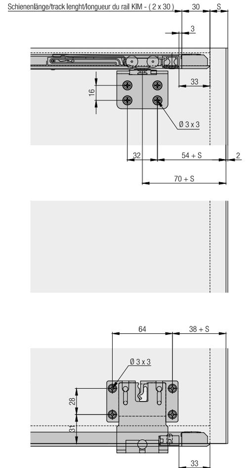
**Garniture pour 1 porte en bois jusqu'à 16 kg, avec réglage en hauteur**
