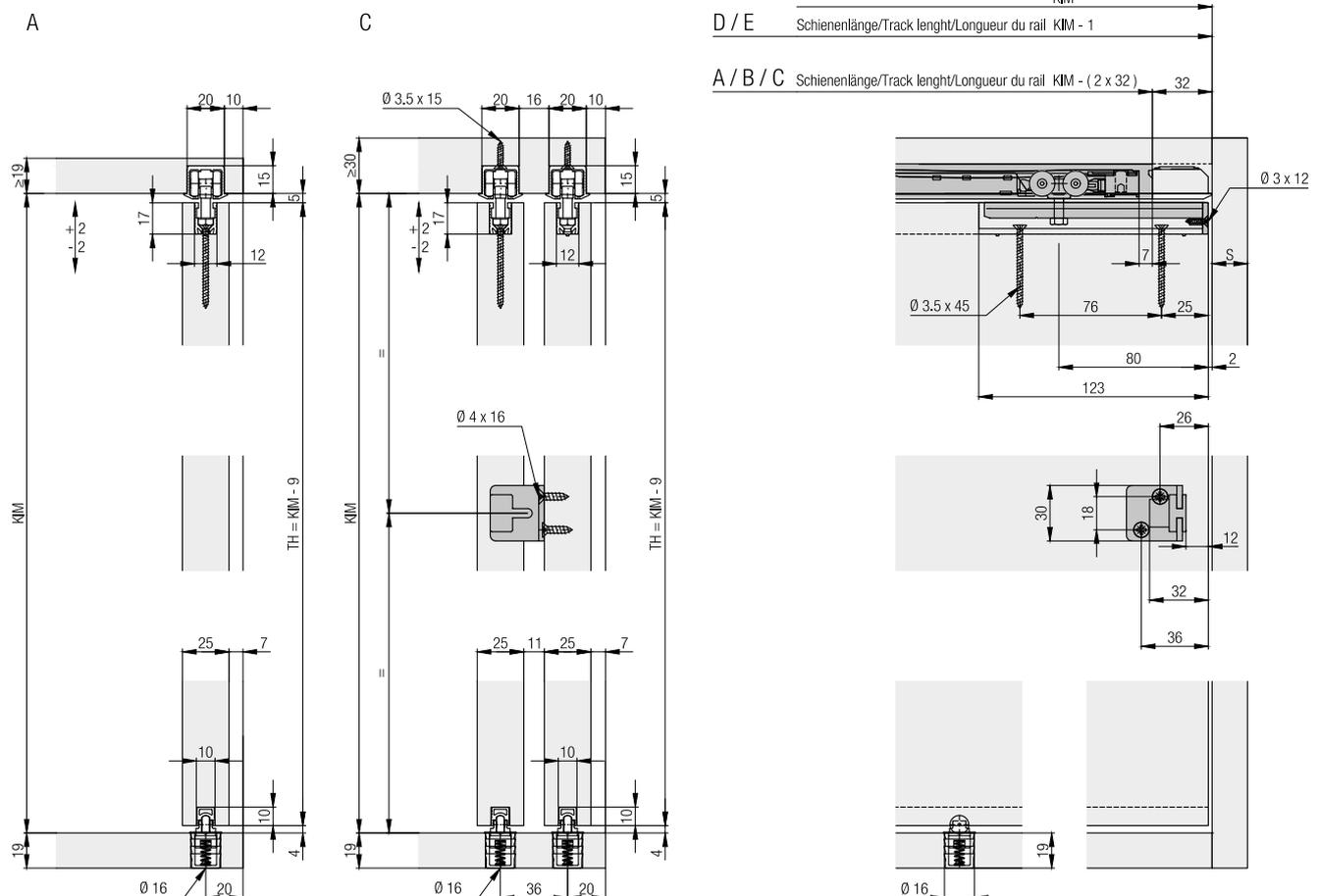
**Garniture pour 1 porte en bois jusqu'à 36 kg, avec réglage en hauteur**
